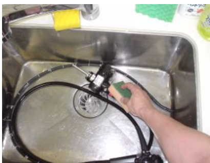
3箇所にボタンがセットされているのを確認 (赤・青・鉗子口/ゴムキャップ)
