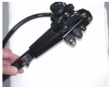
3箇所にボタンがセットされているのを確認 (赤・青・鉗子口/ゴムキャップ)
